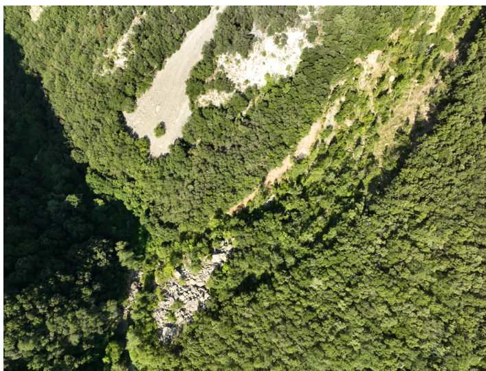
Figura 5-6. Gran esllavissada ocorreguda durant les llevantades del 1982 en l'estret del Bo de Quer entre la Vall del Bac i Oix. Encara s'observa la cicatriu entre les argiles roges i l'enorme acumulació de grans blocs de roca calcària al fons de la riera. Aquesta esllavissada és de les més grans ocorreguda en els darrers 50 anys i ben present en la memòria popular doncs va tallar el camí que anava de la Vall del Bac a Oix.
